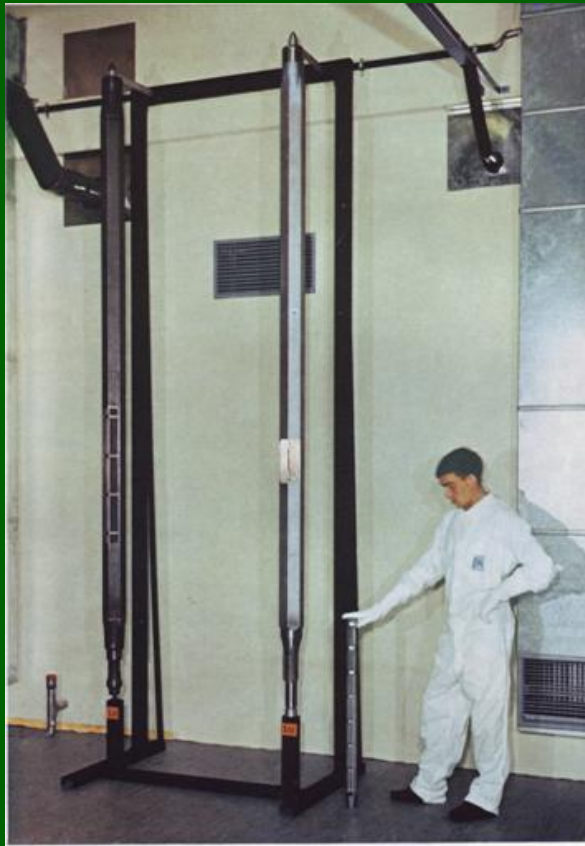
(Photo F. Hamon) Présentation de l'assemblage expérimental Rapsodie Fortissimo (à droite) en regard des assemblages prototypes de cœur (à gauche) et de couverture (au centre) du réacteur SNR 30
